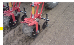
ドラムでやさしく破碎・転圧
