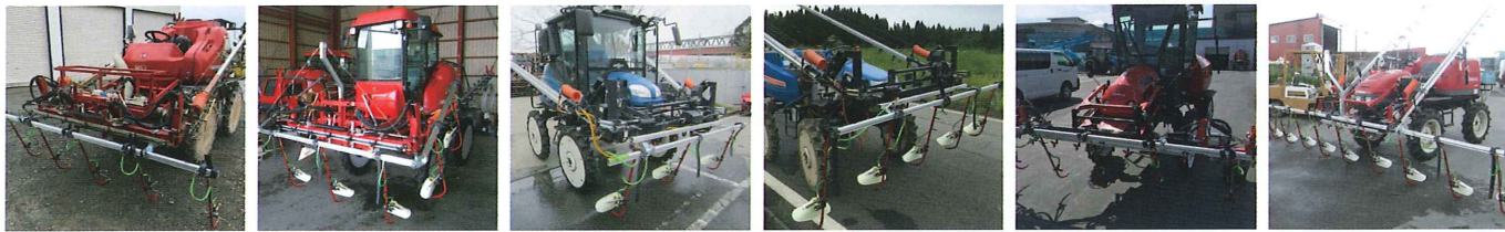
BSB-5A-3-H 5うね・アシュラ3本取付け、北海道仕様 BSB-7C 7うね・カバー付取付け、府県使用 BSB-3C 3うね・カバー付取付け、府県仕様 BSB-5C-H 5うね・カバー付取付け、北海道仕様 BSB-5S-H 5うね・粗粒子取付け、北海道仕様 BSB-9C-H 9うね・カバー付取付け、北海道仕様
