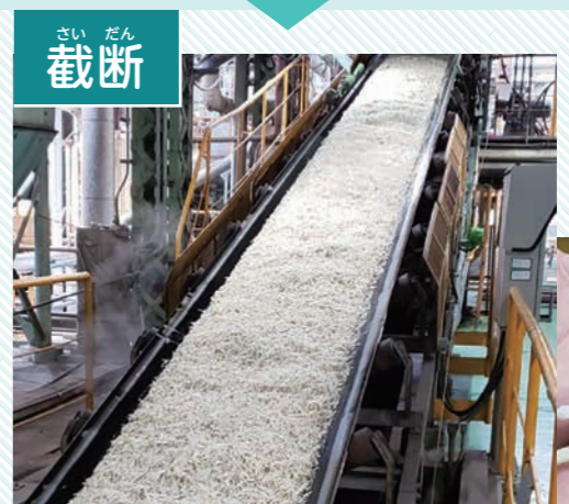
ビートから砂糖を抽出しやすくするために、スライサーを使って千切りにします。こうして得られたビートはコセットと呼ばれます。
