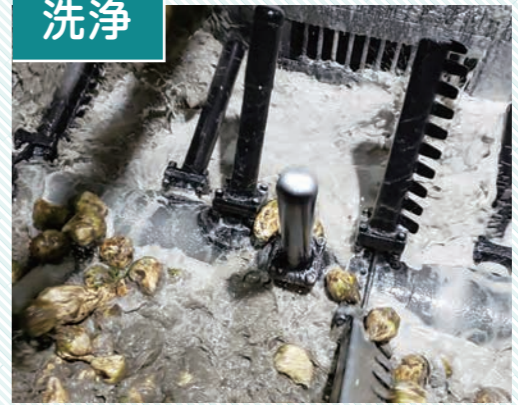
工場に入ったばかりのビートには土や砂などが付着しているため、ビートウォッシャーと呼ばれる機械で綺麗に洗浄します。
