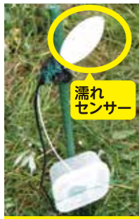
濡れセンサーに 温度計と電圧計を つなぎ測定
