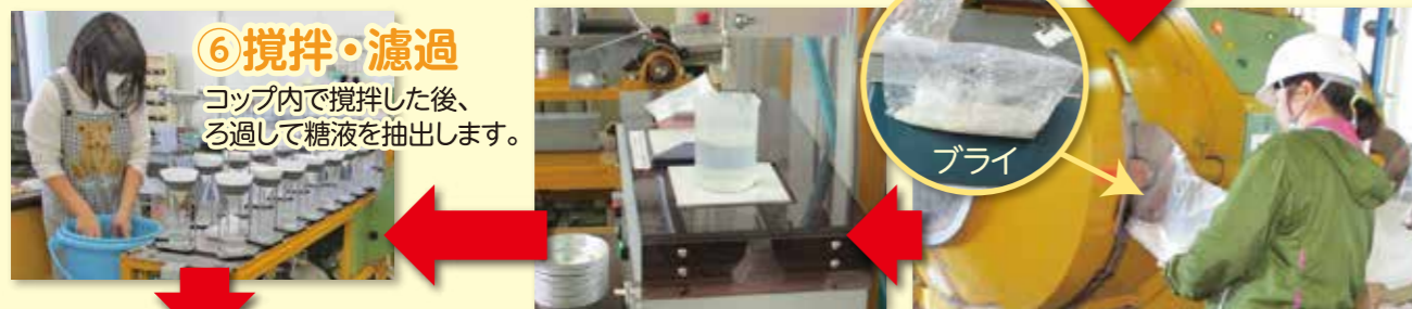
④ソーマシン 回転している刃にサンプルがぶつかることにより、袋の中にすりつぶされたてん菜(ブライと言ひます!)が出てきます。 ⑤ディスペンサー ブライの量に応じた試薬を注ぎ、ブライと混合します。 ⑥攪拌・濾過 コップ内で攪拌した後、ろ過して糖液を抽出します。
