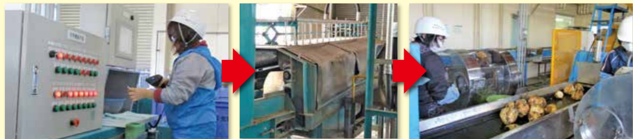
①受付 伝票Noを入力して、てん菜糖分サンプルを管理します。 ②洗浄 サンプルを機械できれいに洗います。 ③タッピング てん菜をタッピングします。
