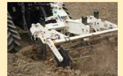
写真: ハーフソイラによる心土破碎の状況
