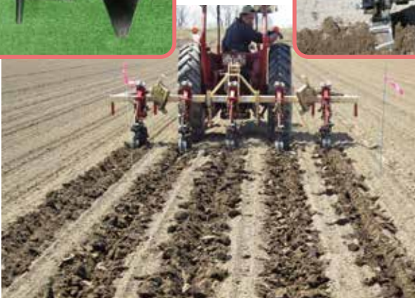
カルチアタッチもりもり施工（北糖農業機材カタログ参照）
