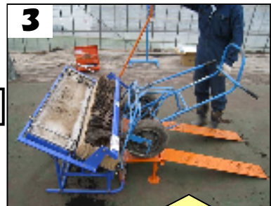
レバーを上げて運搬機が キャッチ
